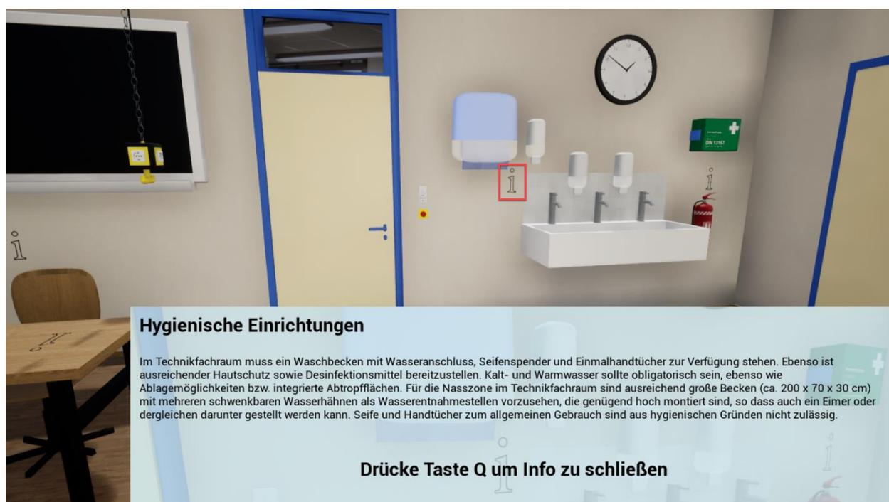
Abbildung 4: Lehrkräftearbeitsplatz und Nasszone mit wichtigen sicherheitsrelevanten Ausstattungselementen sowie Informationstext zu den hygienischen Einrichtungen
