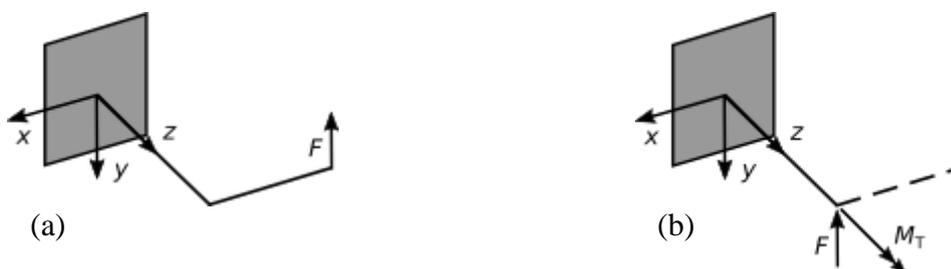
Abb. 2: Prinzipskizze eines Torsions-Zug-Stabs. Die Belastungssituation in (a) lässt sich durch eine im Flächenschwerpunkt angreifende Einzelkraft  $F$  und ein Torsionsmoment  $M_T$  ersetzen (vgl. (b)).
