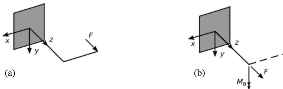
Abb. 1: Prinzipskizze eines Biege-Zug-Stabs. Die Belastungssituation in (a) lässt sich durch eine im Flächenschwerpunkt angreifende Einzelkraft  $F$  und ein Biegemoment  $M_B$  ersetzen (vgl. (b)).
